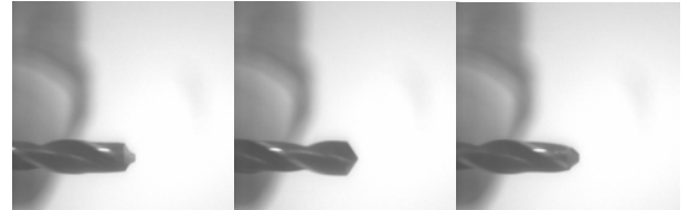
Şekil 1 : Sağlam kesici takıma ait ardışıl imge çerçeveleri
