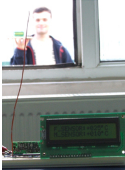
Şekil-5 İki algılayıcı ile elde edilen sonuçların LCD'de gösterilmesi
